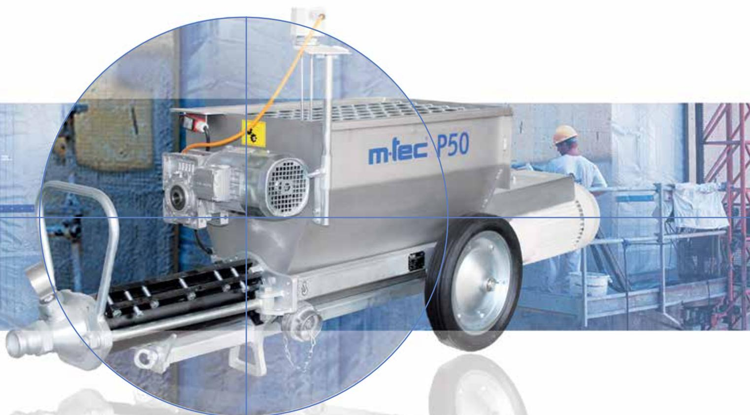
La nouvelle pompe m-tec P50 est une pompe puissante, conçue pour le traitement de produits pompables d'une granulométrie allant jusqu'à 8 mm. Elle est principalement utilisée pour traiter le mortier, le béton, les crépis ou enduits de plâtre, ainsi que les chapes auto-nivellantes. Différentes options avec des débits jusqu'à 140 l/min sont disponibles pour différents terrains d'action.
