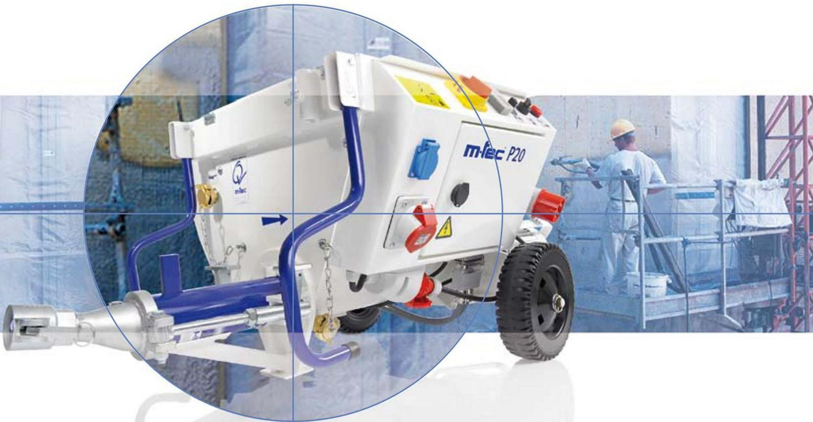
La pompe m-tec P20 est une pompe compacte conçue pour le traitement de matériaux pâteux ou pouvant être pompés, d'une granulométrie allant jusqu'à 5 mm. La P20 est à cet effet principalement utilisée pour le pompage d'enduits de base et de plâtre, à base de résine synthétique et de silicate, de mortier-colle et de sous-couche, de mortier de ragréage et aussi de ponts d'attache.
