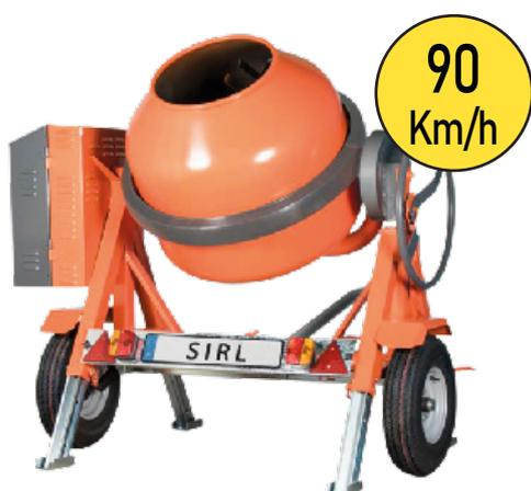
La bétonnière est dotée d'une structure, d'une cuve et d'une ouverture renforcées. Elle dispose de 3 pales double de malaxage mécano-soudées, une couronne et un pignon en fonte, 2 roulements coniques sur l'axe de la cuve, 3 roulements sur l'axe du pignon, un timon homologué double position (anneau et boule) et pieds galva.
