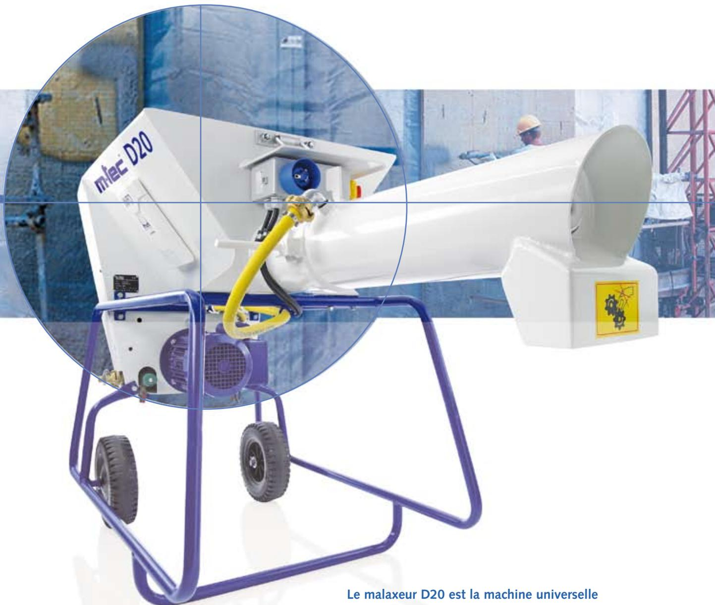
Le malaxeur D20 est la machine universelle et robuste pour le traitement de produits de mortier sec d'une granulométrie allant jusqu'à 4 mm. C'est le malaxeur le plus vendu dans cette catégorie et il permet de rationaliser, selon la variante, le traitement d'enduits de plâtre, de mortier de maçonnerie ou de béton fin.
