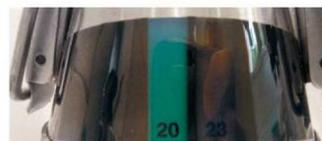
En règle générale, les tables de conversion de tous les appareils CM disponibles sur le marché reposent sur une température ambiante constante de 20 °C. Dans le cas idéal, cette température est enregistrée au début comme à la fin d'une opération de mesure.
